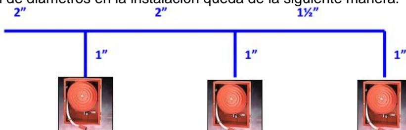
Figura 1.3. Dimensiones de las tuberías de la instalación de BIEs
