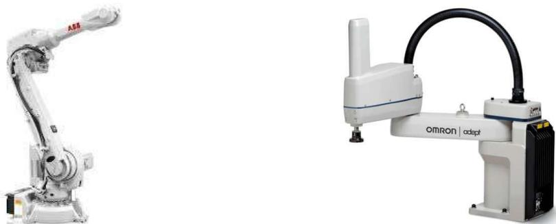
Figura 2.6: Izda: configuración serie de 6 juntas de ABB [17], Dcha: configuración SCARA de OMRON [18]
