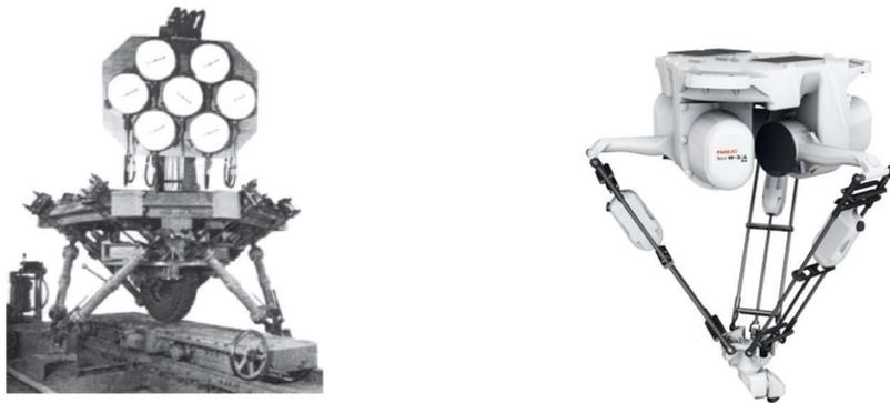
Figura 2.7. Izda: Plataforma de Stewart-Gough [16], Dcha: Robot delta de FANUC [20]
