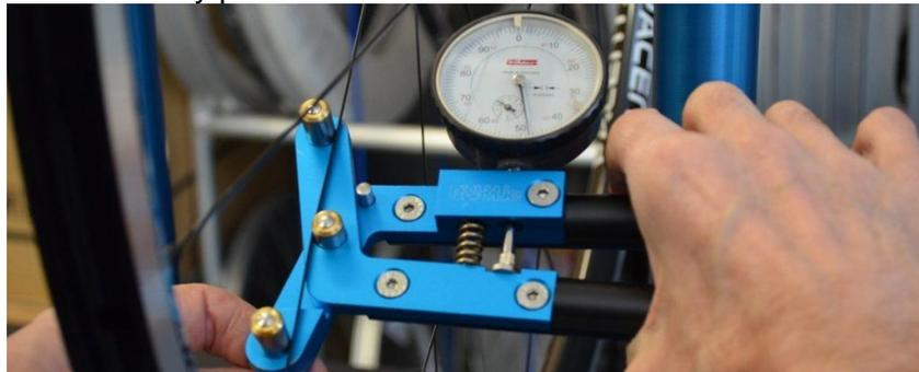
*Ilustración 77; Tensiómetro calibrado.*
