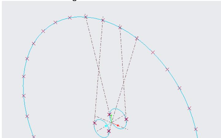
Ilustración 102; Esqueleto de los radios.
