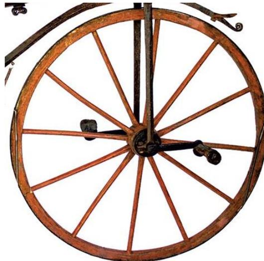
*Ilustración 6; Rueda de madera de un Velocípedo.*
