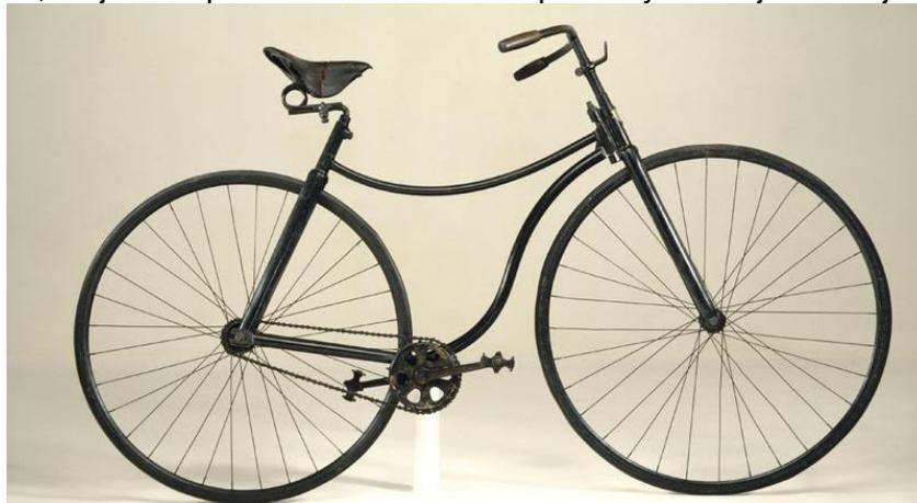
*Ilustración 7; Bicicleta de Seguridad Rover o Safety Rover.*
