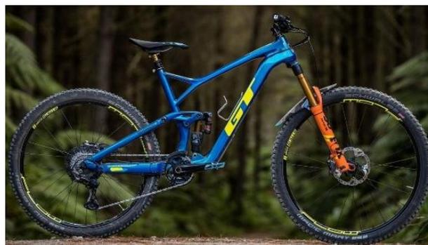
Ilustración 28; Bicicleta GT con rueda delantera de 29" y rueda trasera de 27.5".
