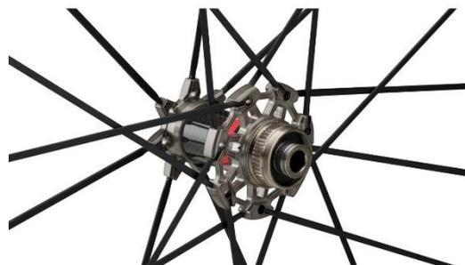
Ilustración 48; Ejemplo del patrón de radiado mixto.
