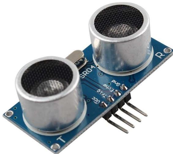
Figura 16: Módulo sensor de ultrasonidos HC-SR04. Imagen obtenida de amazon.es
