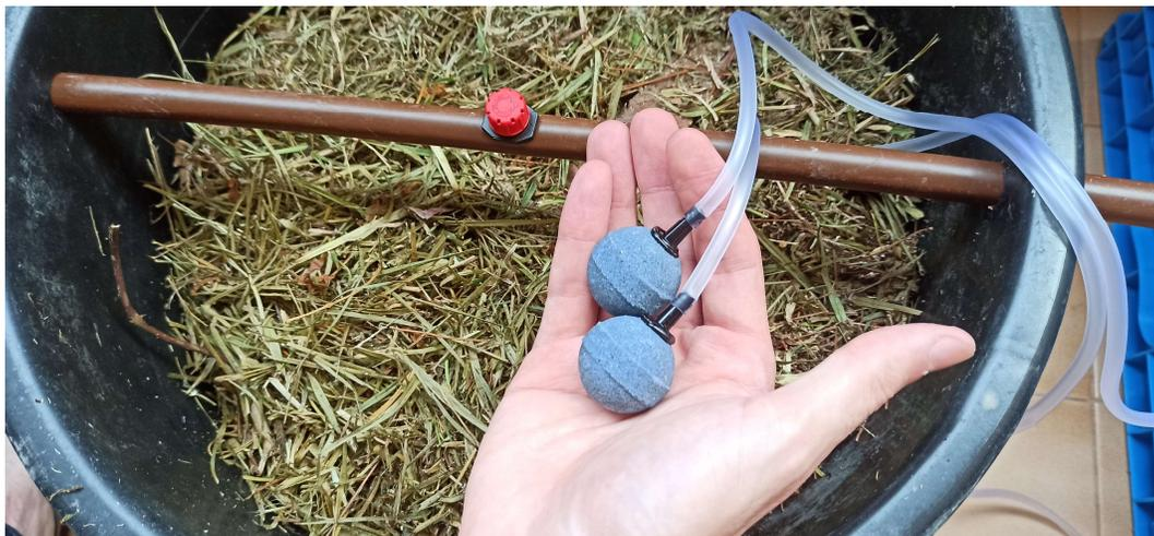
*Figura 29: Detalle de los difusores de piedra para la salida del aire y el gotero de riego. Imagen producida por el autor.*
