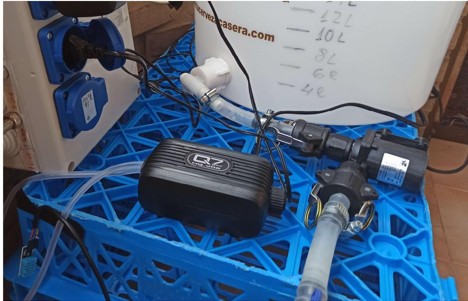
*Figura 28: Detalle de las conexiones entre bomba, depósito y tubería de riego mediante conectores rápidos. Imagen producida por el autor.*
