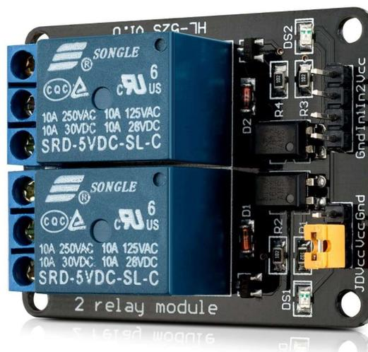
Figura 17: Módulo de relés dos canales 5V. Imagen obtenida de amazon.es
