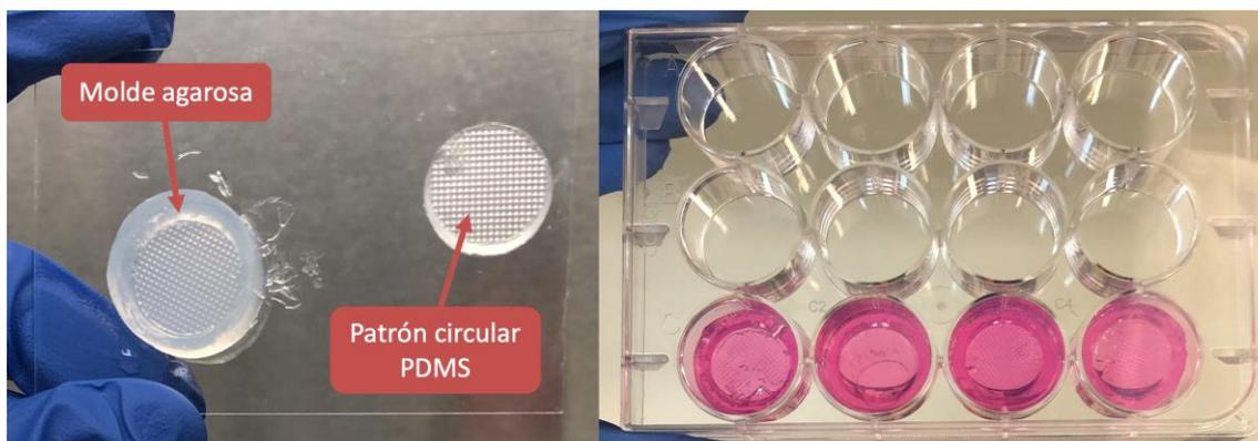
**Figura 43.** Molde de agarosa producido a partir de moldes de PDMS (izquierda) y moldes de agarosa encajados perfectamente en una placa de 12 pocillos (derecha).
