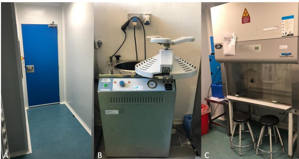
**Figura 37.** Sistemas de mantenimiento de la asepsia. Entrada a una sala blanca (A), autoclave (B) y cabina de flujo laminar (C).
