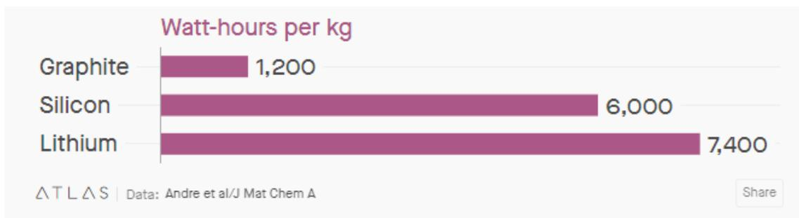
Figura 28: Materiales útiles para los ánodos
