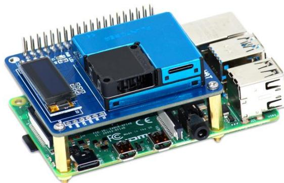
Figura 9. Air Monitoring HAT para Raspberry Pi – HAT Monitoreo de aire
