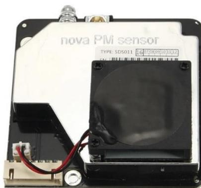
Figura 8. Nova PM Sensor SDS011 – Sensor de calidad del aire de alta precisión láser PM2.5
