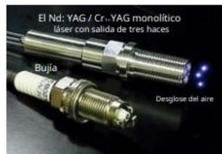
Figura [2.3.1]: Micro-encendedor láser con tres rayos de salida. Fuente: [6]
