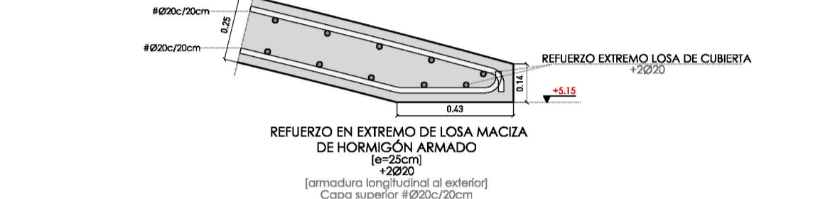
FORJADO PLANTA BAJA CUBIERTA ESCALA: 1/20
