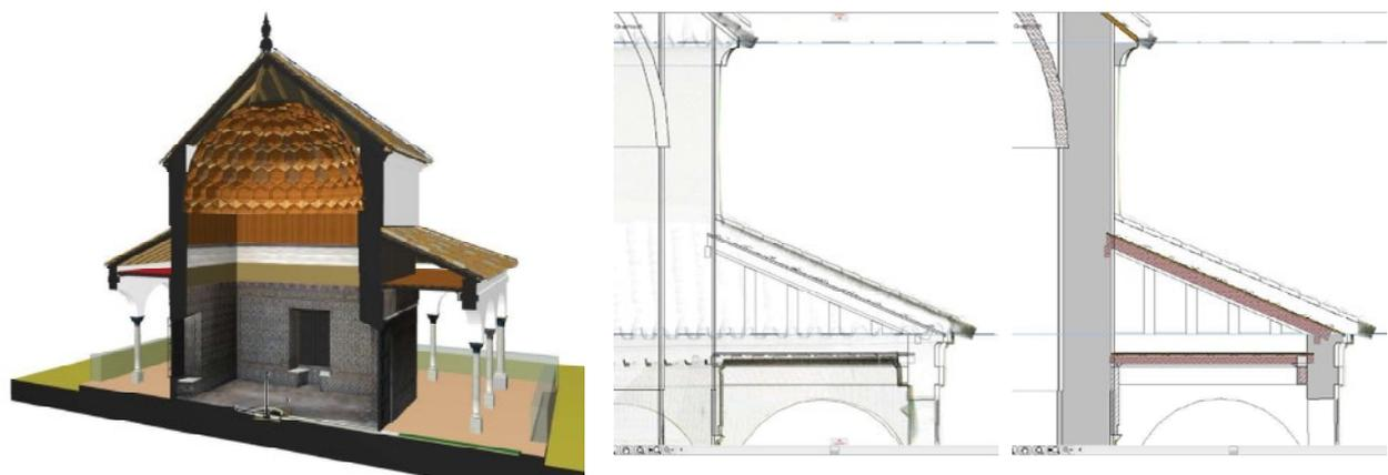
Figura 24: Sección 3D modelado con y comparativa del muro sobre el faldón de cubierta del modelo con la imagen de referencia en ArchiCAD 16/17. (Nieto Julián et al., 2014)
