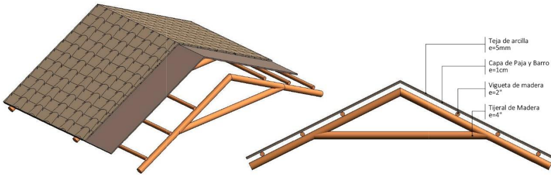
Figura 137. Detalle de cubierta de teja de arcilla - Caso de Estudio N° 2. Fuente: Elaboración propia (2021)
