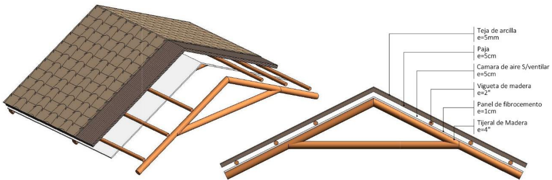
Figura 187. Detalle de mejora de la cubierta de teja de arcilla - Caso de Estudio N° 2. Fuente: Elaboración propia (2021)
