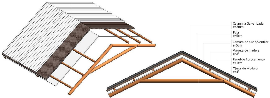
Figura 186. Detalle de mejora de la cubierta de calamina - Caso de Estudio N° 2. Fuente: Elaboración propia (2021)
