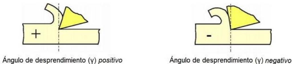
Figura 13. Ángulos de desprendimiento según su posición
