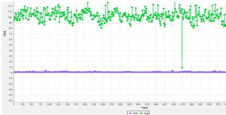
Figura 68. Valores I_d e I_q después de los controladores PI
