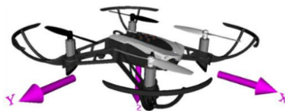
Figura 3.2: Ejes del sistema de referencia centrado en el dron
