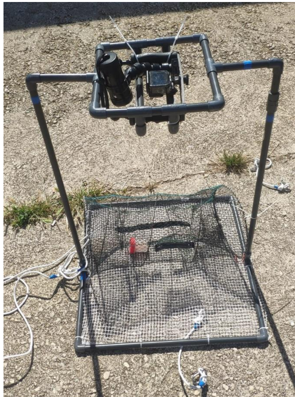
Figura 4. Estructura montada. Base(0'65x0'65m), Altura(0'85m).
