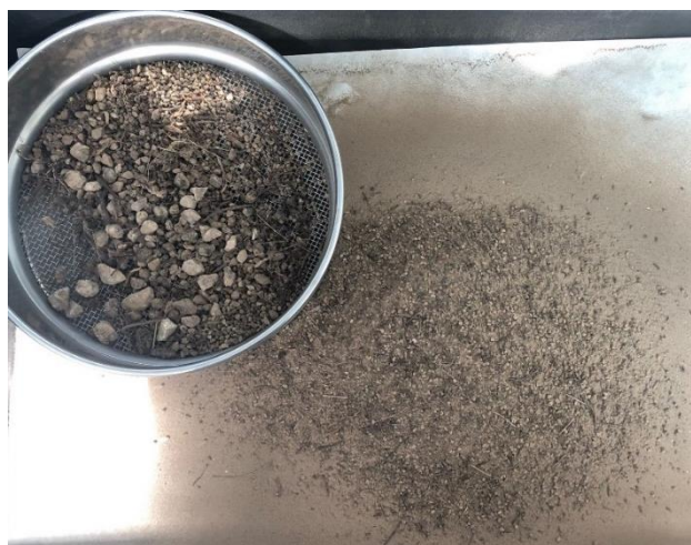
Figura 9: Separació d'elements fins i gruixos.
