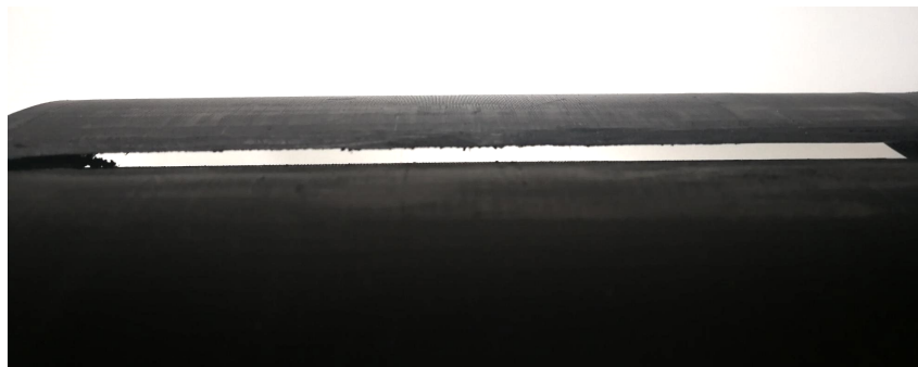
Figura 1.2. Detalle de slot (ranura) en extradós para energizar la capa límite en un perfil de prueba, impreso en 3D
