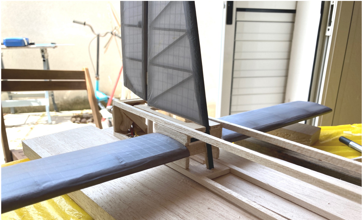
Figura 4.12. Encastre de la cola completado
