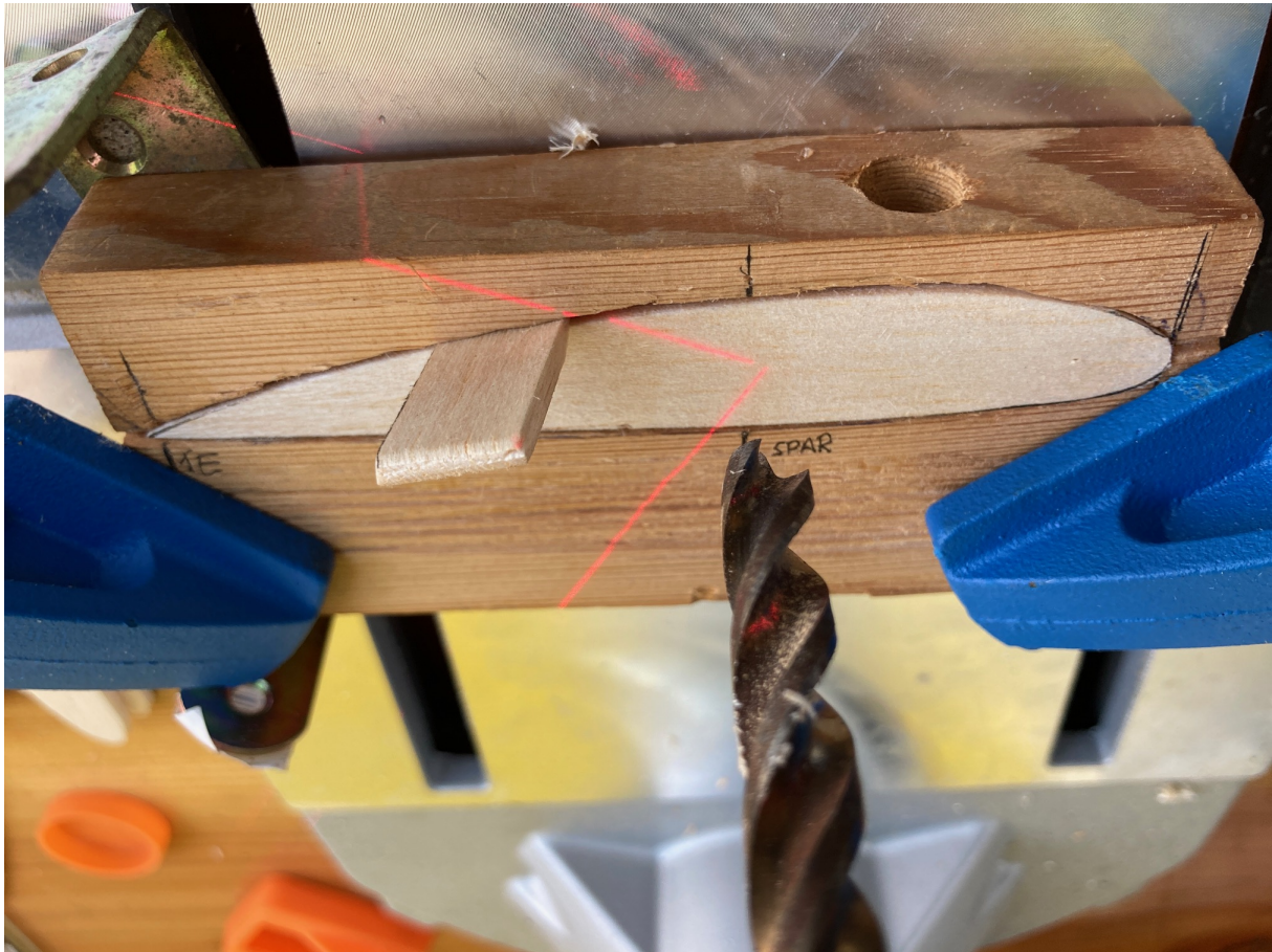
Figura 4.5. Plantilla del perfil alar, realizando los orificios para los largueros de carbono con un taladro de precisión
