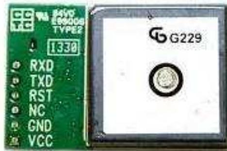
Figura 12: Pines conexión del Skylab SKM53 <sup>[12]</sup>
