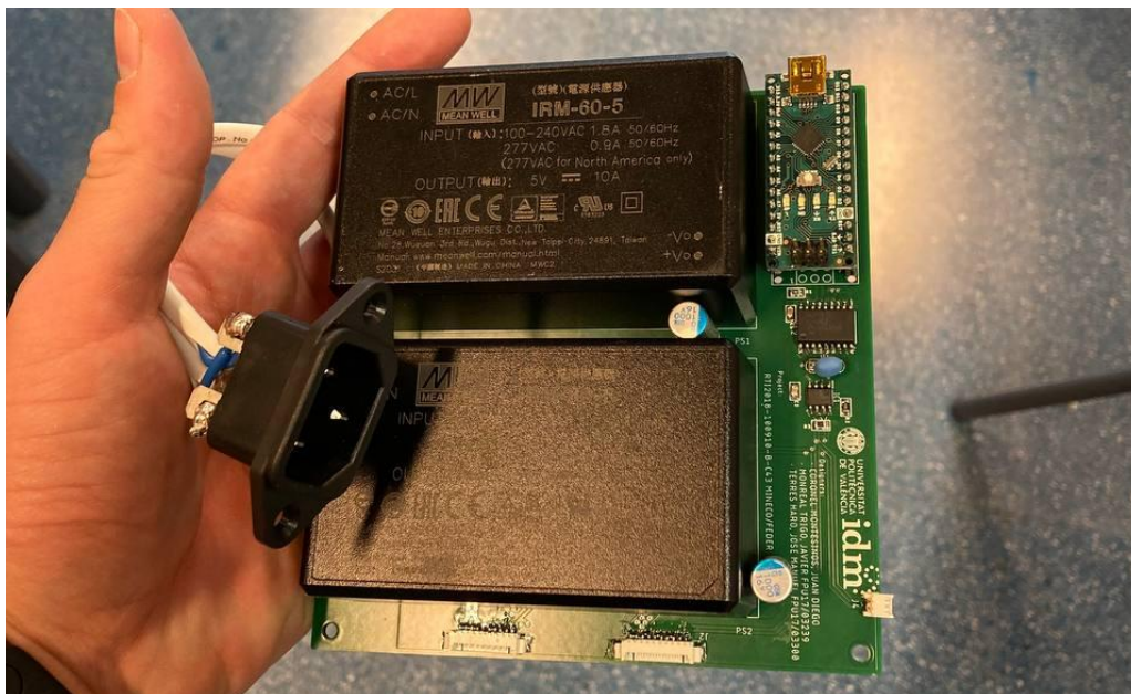
Figura 4. Prototipado de OSIVE HI Power Station (100 W, 20 A, 5 V). Fuente: Propia
