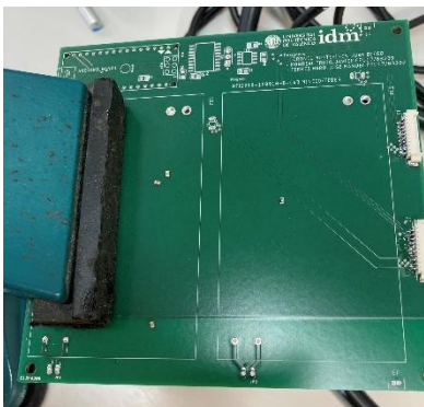
Figura 42. PCB de OSIVE HI sin componentes, asegurada en el banco de trabajo. Fuente: Propia.
