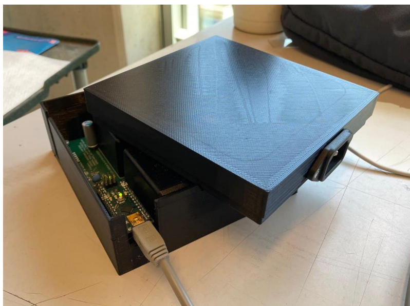
Figura 44. Unidad central de OSIVE HI ensamblada en encapsulado. Fuente: Propia.
