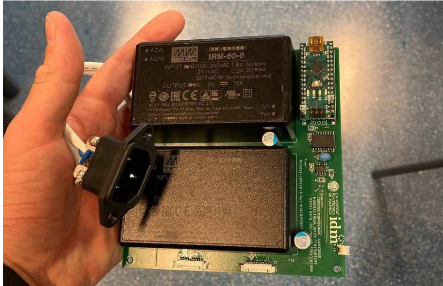
Figura 43. Unidad central de OSIVE HI, después de soldar todos los componentes a la PCB. Fuente: Propia.
