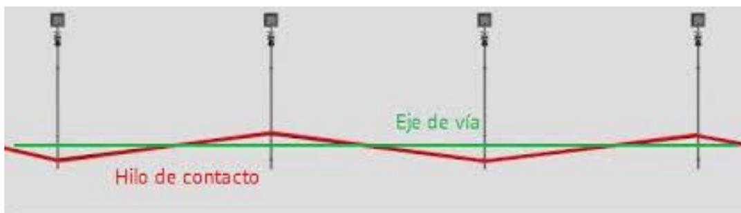
FIGURA 4 - DESCENTRAMIENTO DEL HILO DE CONTACTO.
