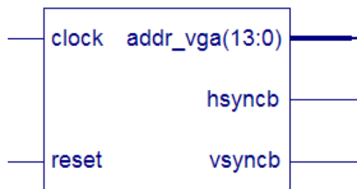
Figura 3.54. Top del controlador VGA
