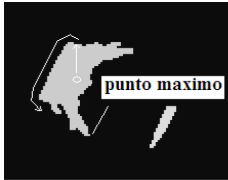
Figura 3.87. Imagen representativa del recorrido del algoritmo para encontrar el primer punto más lejano
