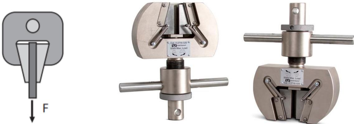
Figura 47. Mordazas de agarre en cuña Instron. Fuente: [31]
