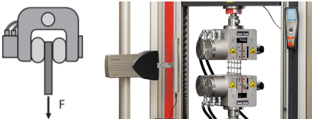
Figura 46. Mordazas hidráulicas Zwick/Roell. Fuente: [30]
