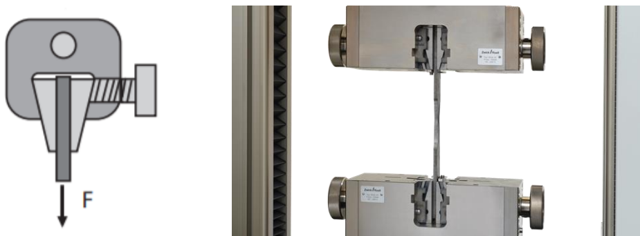
Figura 48. Mordazas tornillo-cuña Zwick/Roell. Fuente: [32]
