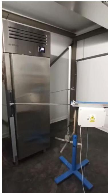
**Figura 57. Brazo robótico para ensayos Armario de baja temperatura.**
