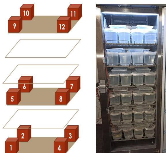
Figura 55. Distribución de carga armario de baja temperatura.
