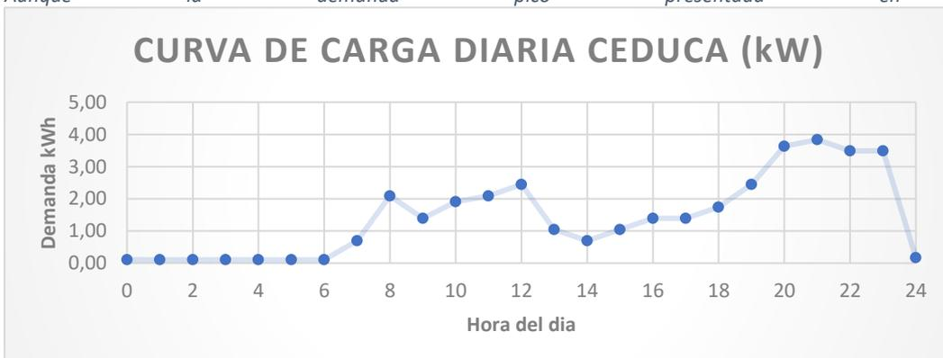
Figura 8 en el día es de 3.84 kW, en este trabajo se utilizará la demanda pico referente a la potencia mínima necesaria para la generación de las energías renovables calculada por la  $P_{pico} =$
