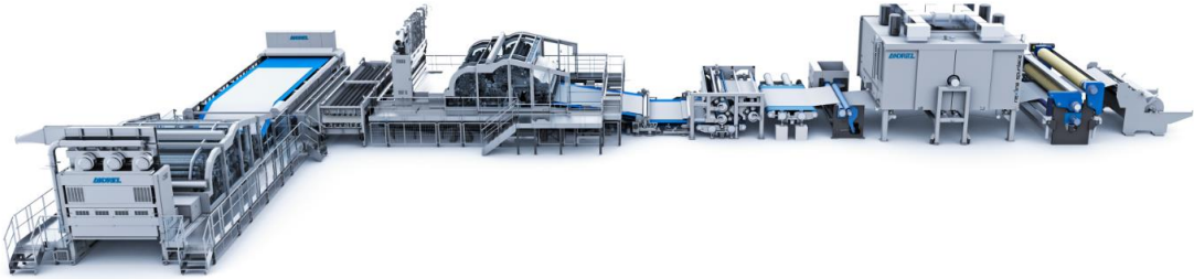
Ilustración 31: Maquinaria de fabricación de no tejidos por vía seca y consolidado Spunlaced. (52)
