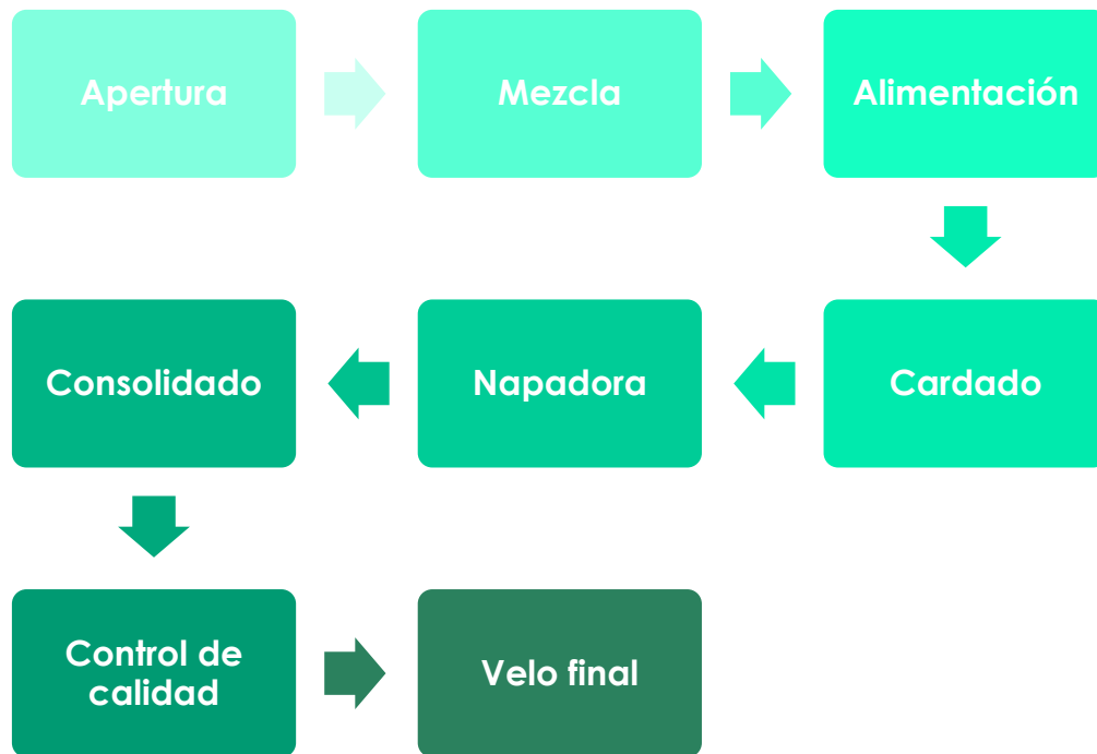
Ilustración 32: Esquema del proceso de fabricación de un no tejido por vía seca.
