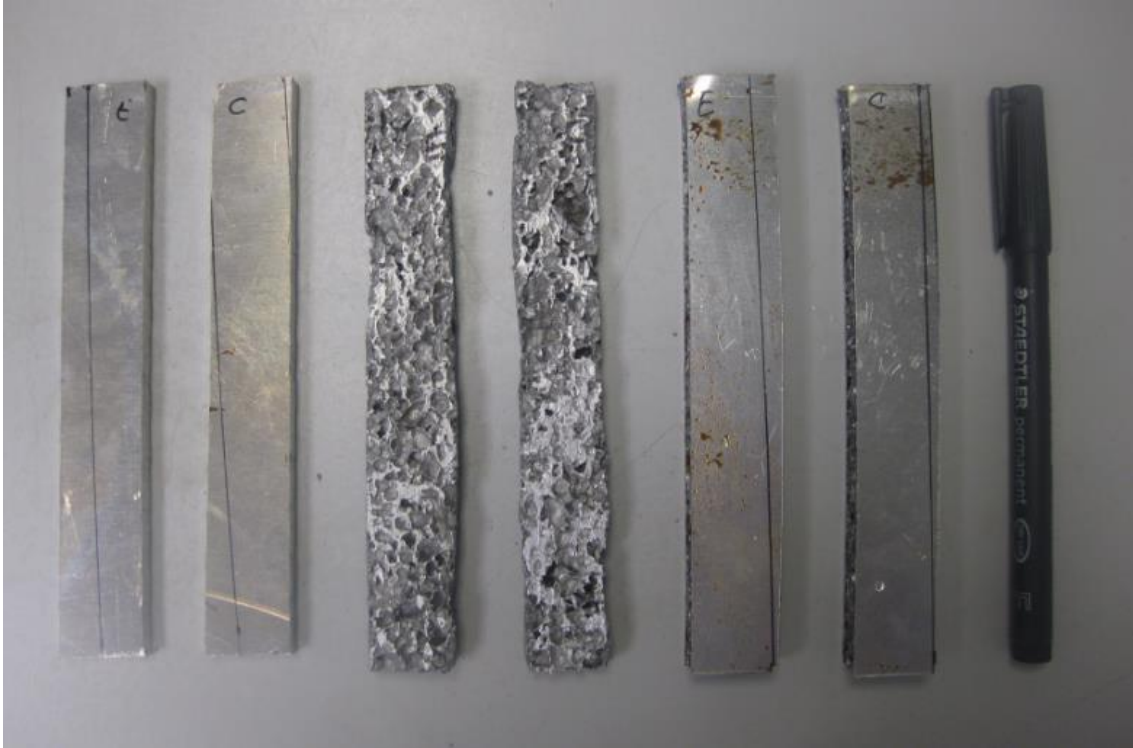
Ilustración 5.2.3-5-10 Probetas a ensayar, de izquierda a derecha aluminio, espuma de aluminio y sandwich.
