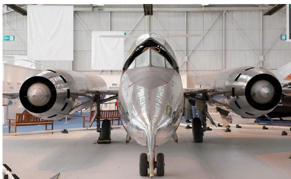
Ilustración 4-1: Bristol 188, aeronave supersónica de 1950, con recubrimiento de acero inoxidable.
