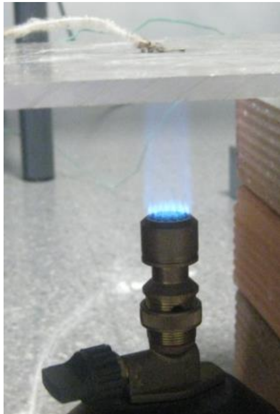
Ilustración 5.2.1-3. Aluminio siendo expuesto a la llama.
