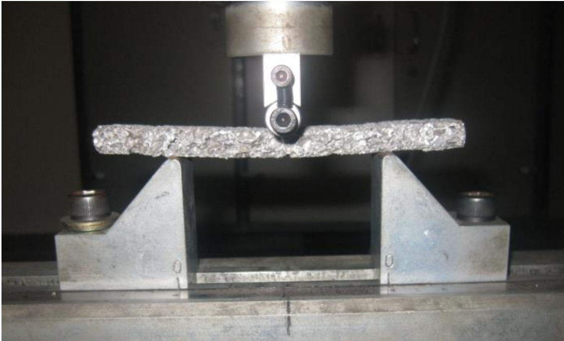
Ilustración 5.2.3-4. Colocación de la probeta, distancia entre los apoyos de 80mm.
