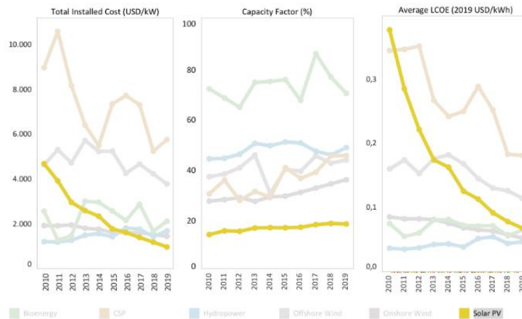
Figura 21. Promedio del coste total por potencia instalada, del factor de capacidad y del LCOE de las tecnologías durante 2010-2019. Fuente: IRENA [22]
