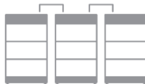
Figura 55. Símbolo de la conexión en paralelo de 3 racks de baterías. Fuente: BYD.[46]
