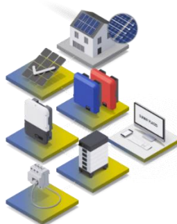
Figura 53. Gestión de la energía de la instalación. Aparecen la instalación fotovoltaica, el inversor de red, el inversor/cargador de las baterías, el rack de baterías, el SMA Data Manager, el Sunny Portal y el Sunny Home [43]
