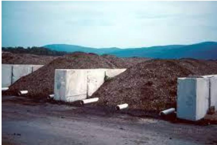
**Figura 29. Tuberías aireación.**
