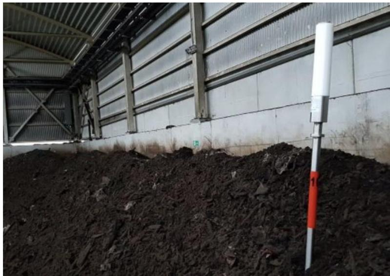
Figura 12. Control temperatura en pilas de compostaje.
