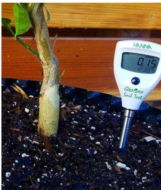
Figura 16. Medidor CE.
