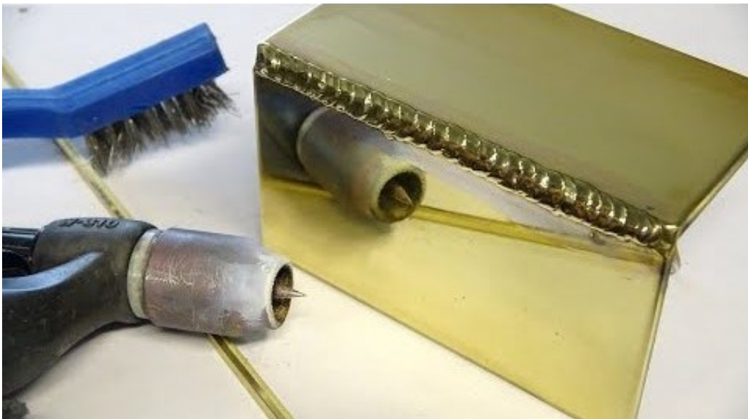
Ilustración 51: Soldadura de latón
