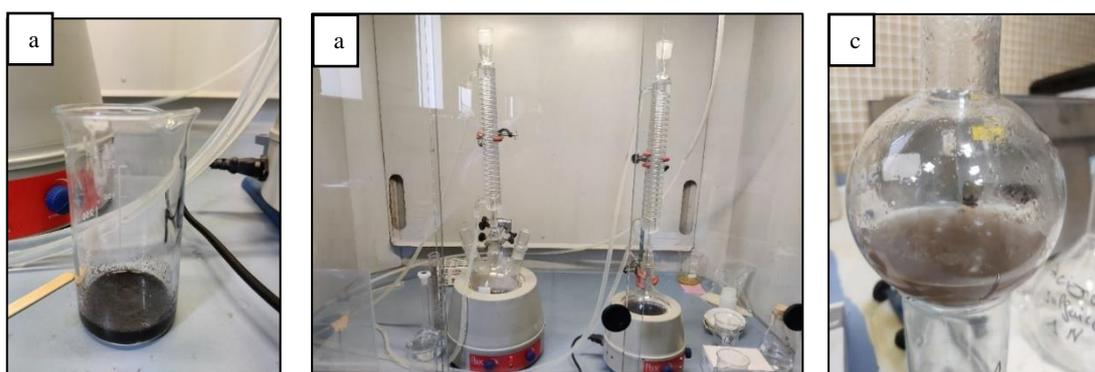
Figura 17: (a) precipitado obtenido después el ataque ácido a 72% (b) montaje a reflujo (c) muestra deslignificada
