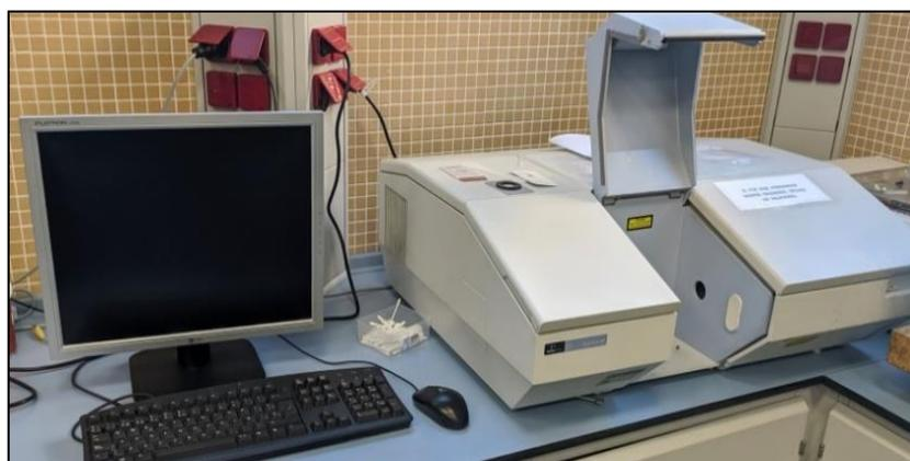
Figura 12: Perkin Elmer® FTIR-ATR
