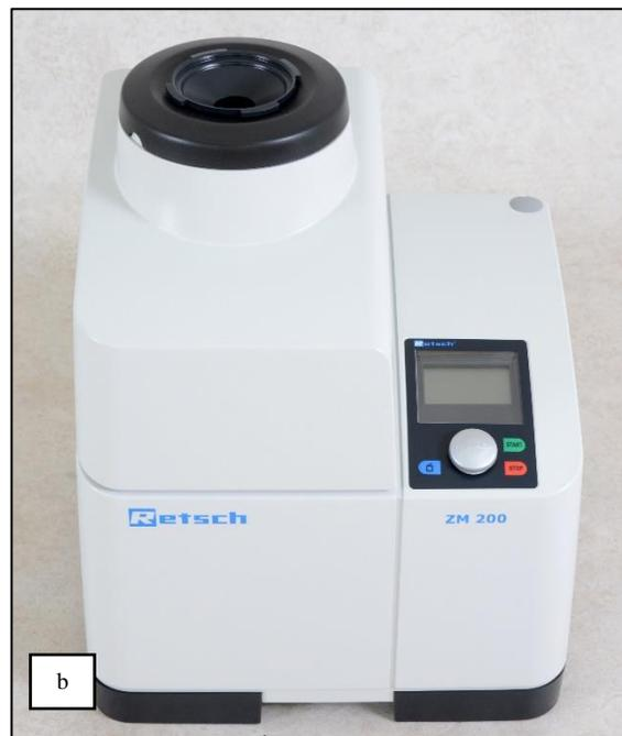
Figura 9: (a) trituradora industrial (b) micronizadora 250 $\mu\text{m}$
