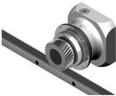
Figura 10. Piñón cremallera. En la imagen se puede observar el sistema de engrane de un piñón que gira en un eje y transmite movimiento rectilíneo a través de una barra dentada. ( Piñón Cremallera , n.d.)
