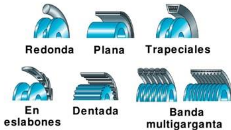
Figura 21. Tipos de correas. En esta imagen se puede ver los distintos tipos de correas que existen.( Tipos de Correas , n.d.)
