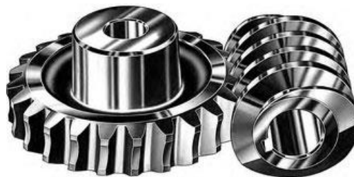
Figura 8. Engranaje de tornillo sin fin. Esta imagen representa un conjunto de rueda dentada y tornillo sin fin para montar en ejes cruzados. (Nicolas E. Modesti, n.d.)
