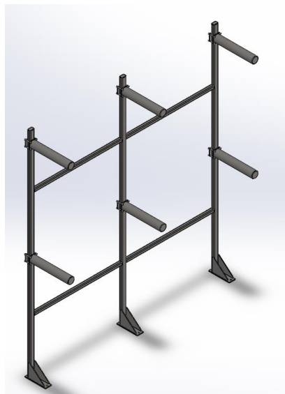
Figura 30. Percha triple de almacenaje. En la figura se puede observar que cada percha es capaz de almacenar 6 neumáticos.
