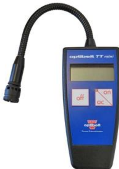
Figura 108. Medidor de frecuencia optibelt TT mini. En la imagen se observa un medidor de frecuencia para determinar la tensión de las correas.
