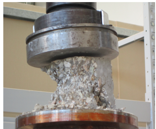
Figura 3.5.2. Probeta rota a compresión
