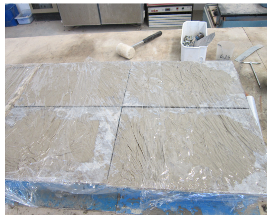
Figura 3.4.6. Tapado de las probetas
