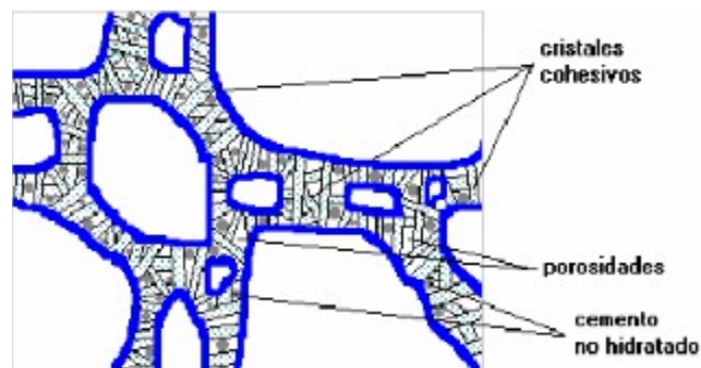
Figura 1.7.1. Estructura interna de hormigón endurecido.
