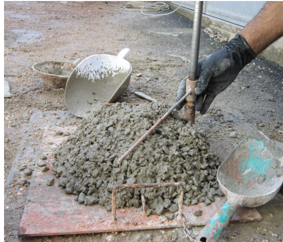
Figura 3.4.2 Ensayo Cono de Abrams M1
