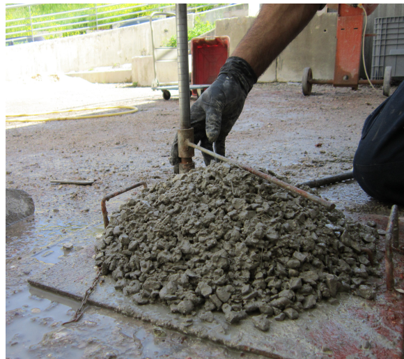
Figura 3.4.3 Ensayo Cono de Abrams M2
