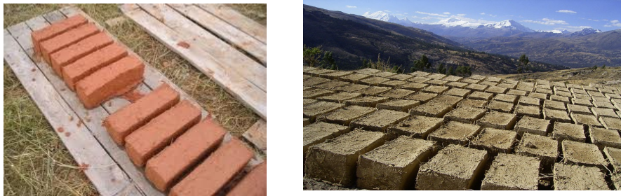
Figura 1.1.1. Ladrillos de barro reforzados con paja.
