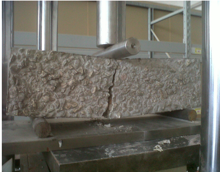
Figura 3.6.4. Probeta M3(600g fibras de acero)rota a flexión
