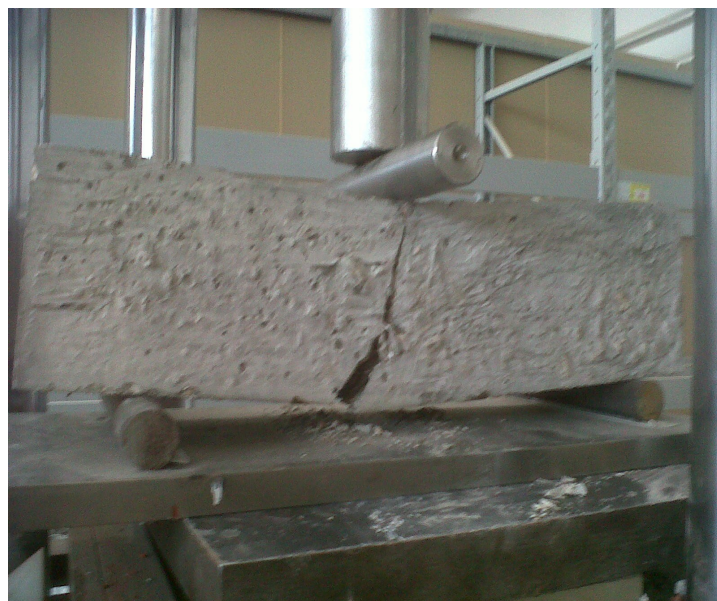
Figura 3.6.5. Probeta M4(1200g fibras de acero)rota a flexión
