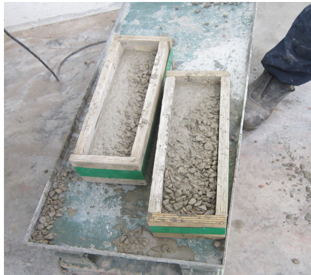
Figura 3.4.4. Vibrado de probetas
