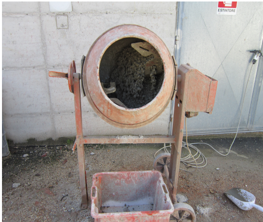
Figura 3.4.1 Preparación del hormigón en la Hormigonera
