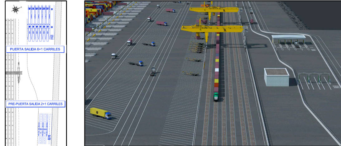
Ilustración 26 Puertas de salida y zonas de espera para camiones en la terminal VNPT. Fuente: TiL/MSC
