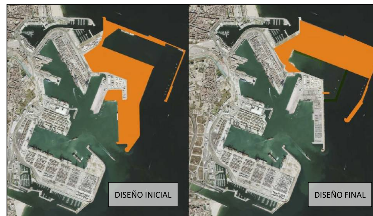
Ilustración 13 Cambio de ubicación de la nueva terminal de la Ampliación Norte del Puerto de Valencia. Fuente: Periódico El País
