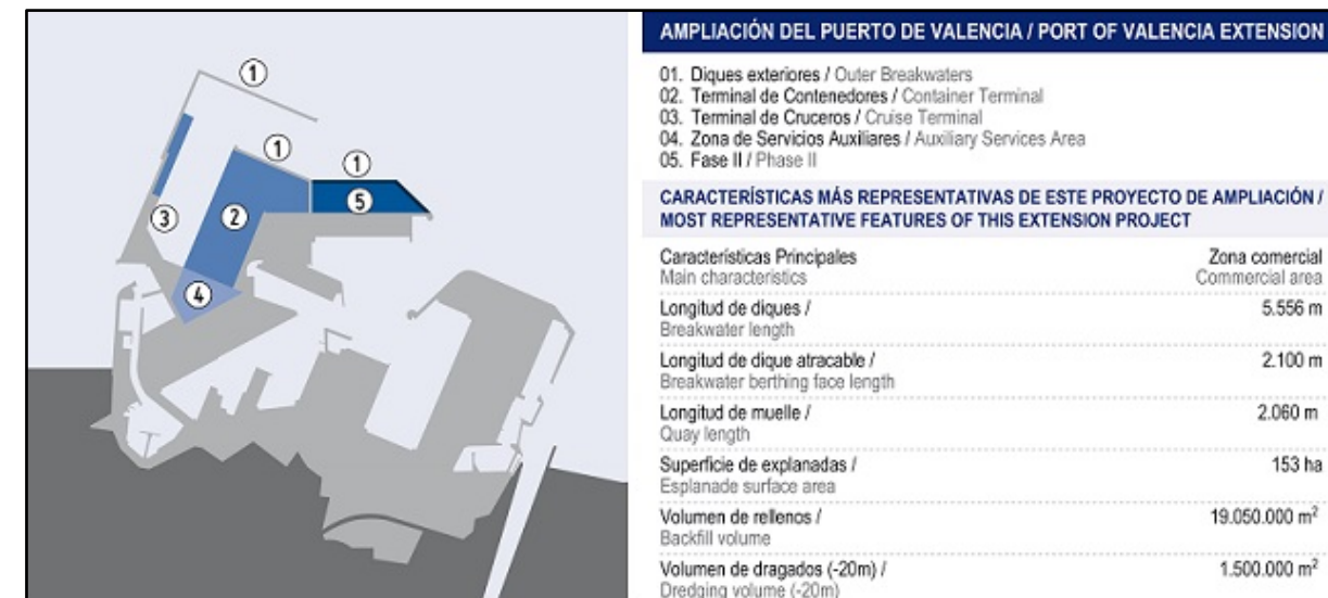
Ilustración 12 Características más representativas del proyecto de la Ampliación Norte del Puerto de Valencia. Fuente: valenciaport
