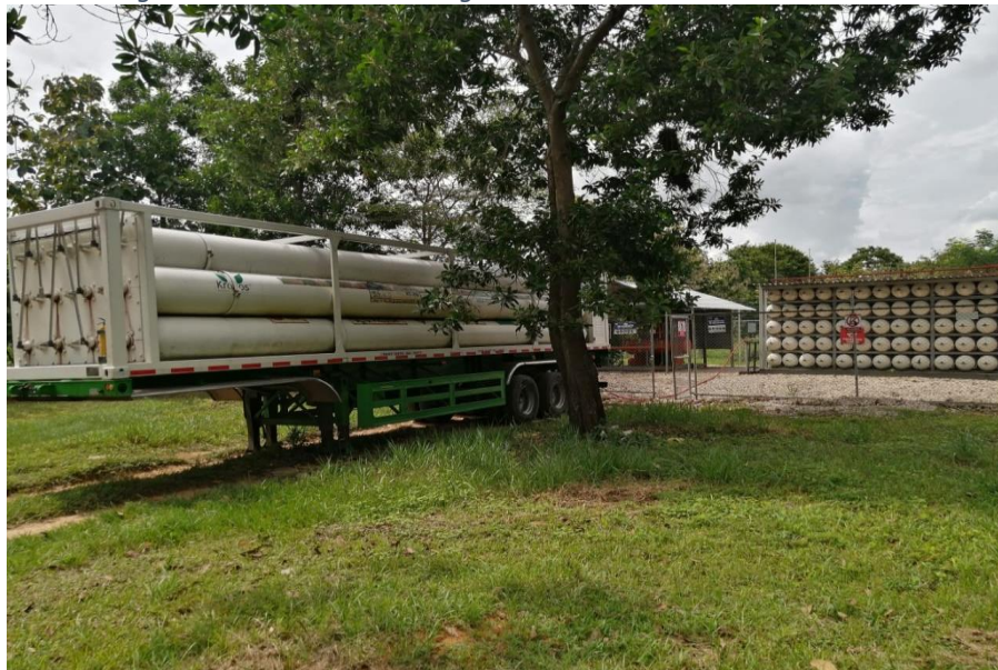
Figura 15. Proceso de descargue del módulo de almacenamiento.
