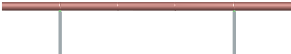
Figura 51. Modelo de estudio con 84 m de luz del vano central con anillos de rigidización cada 28 m. Fuente: Elaboración propia
