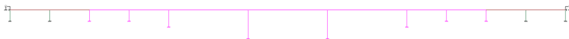
Figura 30. Modelo simplificado de evaluación para viaducto del hyperloop para luces medias. Ejemplo de vano central de 56 m.
