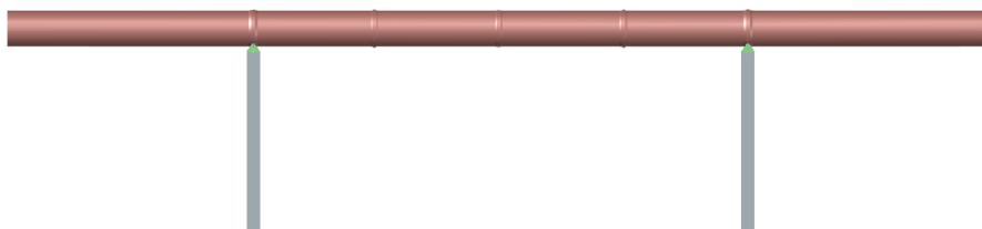
Figura 50. Modelo de estudio con 56 m de luz del vano central con anillos de rigidización cada 14 m. Fuente: Elaboración propia
