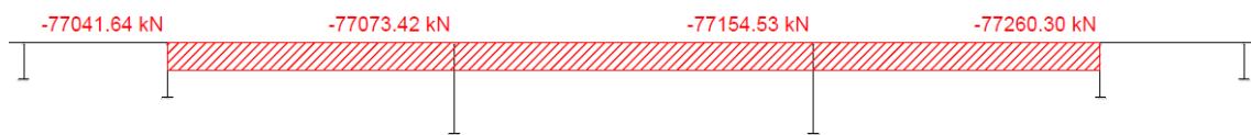
Figura 74. Diagrama de esfuerzo axiles en los tres vanos centrales del modelo del viaducto para hyperloop de 63 m de vano central. Fuente: Elaboración propia
