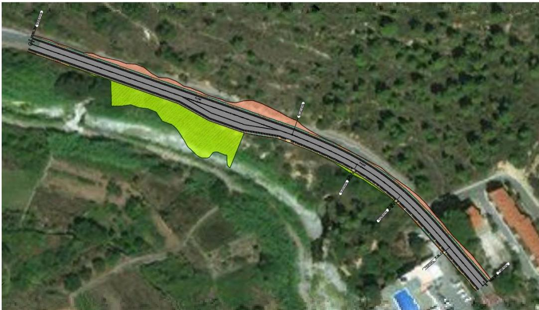
Figura 20: Obra lineal de chicane en el Civil 3D
