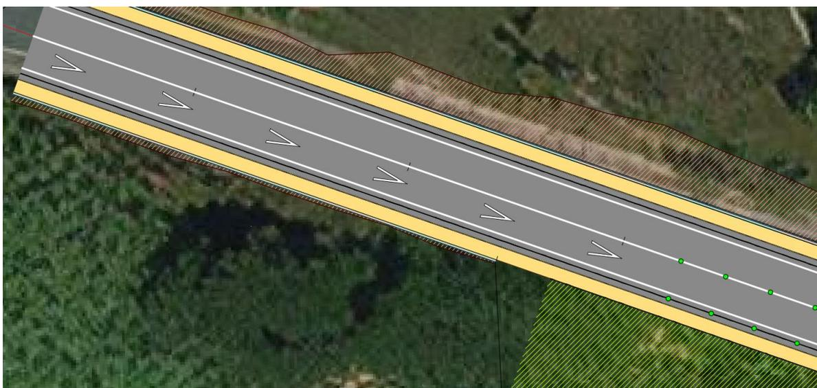
Figura 7: Implantación de marcas viales tipo galón.
