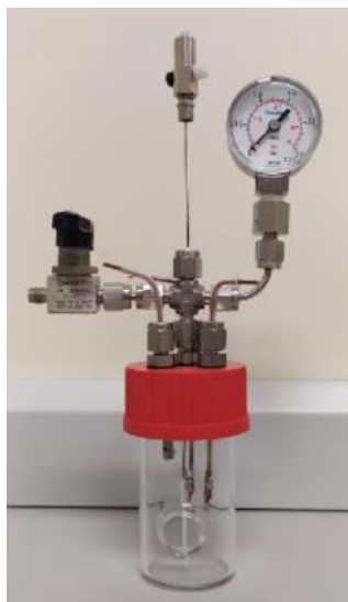
Figura 34. Celda electroquímica usada para las técnicas electroquímicas.
