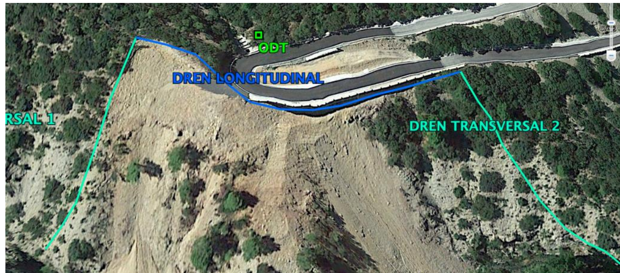
Ilustración 89 Vista de la ubicación de los drenes longitudinal superficial y transversal 1 y 2. Fuente: Google Earth
