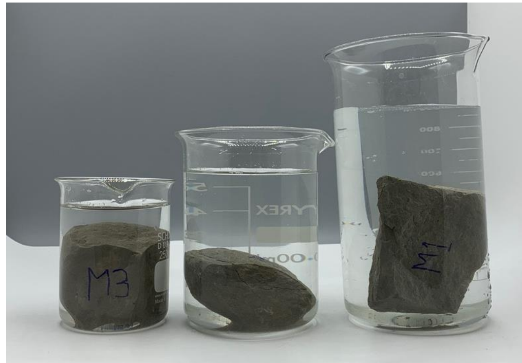
Ilustración 53 Muestras de marga sumergidas en el ensayo de alterabilidad al inicio. Fuente: Elaboración propia
