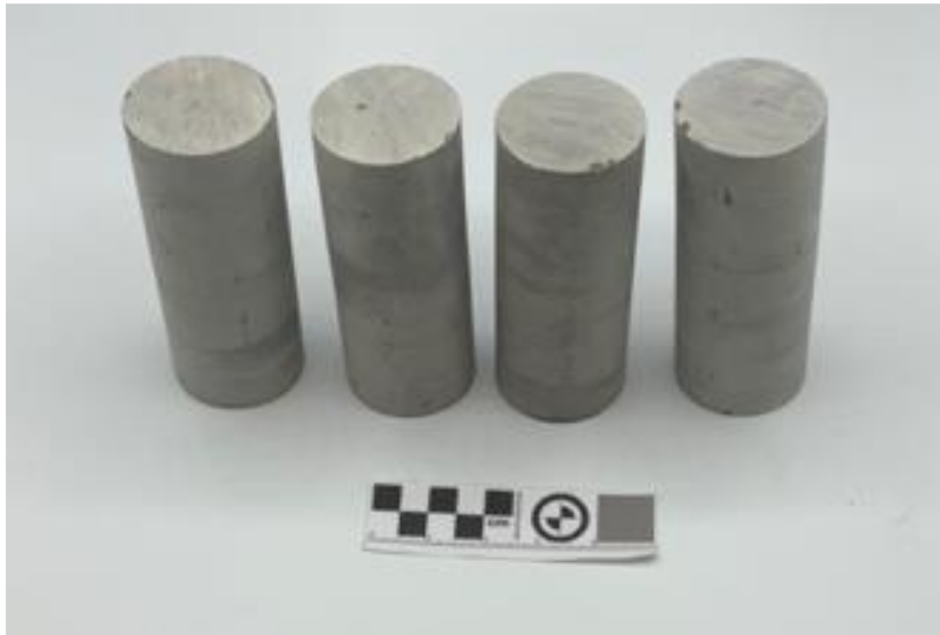
Ilustración 52 Las 4 probetas que se eligen para el ensayo de compresión simple. Fuente: Elaboración propia
