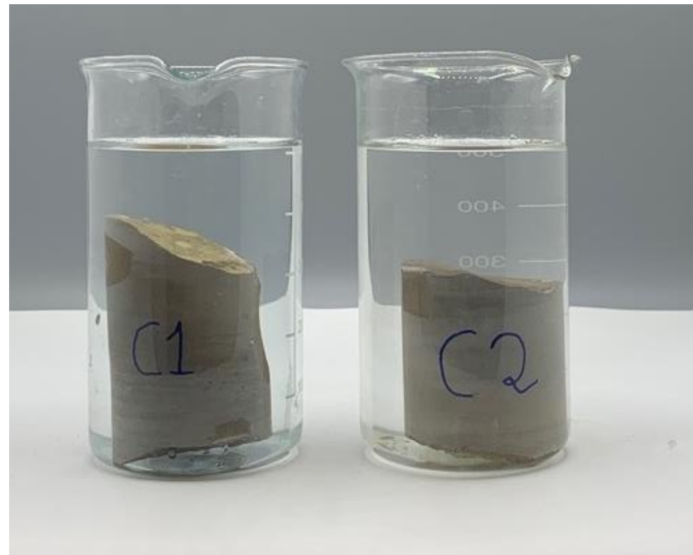
Ilustración 54 Muestras de caliza sumergidas en el ensayo de alterabilidad, al inicio. Fuente: Elaboración propia
