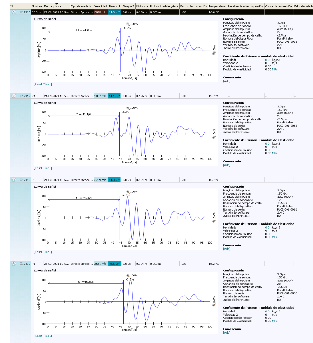
Ilustración 62 Resultados mostrados por el software de impulsos de ultrasonidos a las muestras: P1, P2, P3 y P4. Fuente: Aplicación de registro de datos Pundit Lab +.
