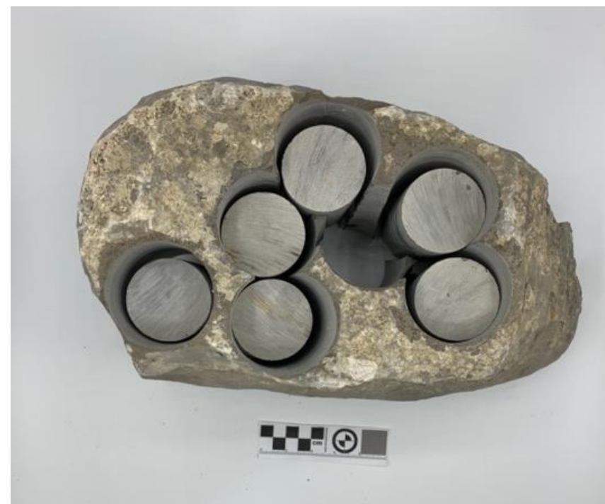
Ilustración 46 Roca caliza de donde se extraen las probetas a estudiar. Fuente: Elaboración propia
