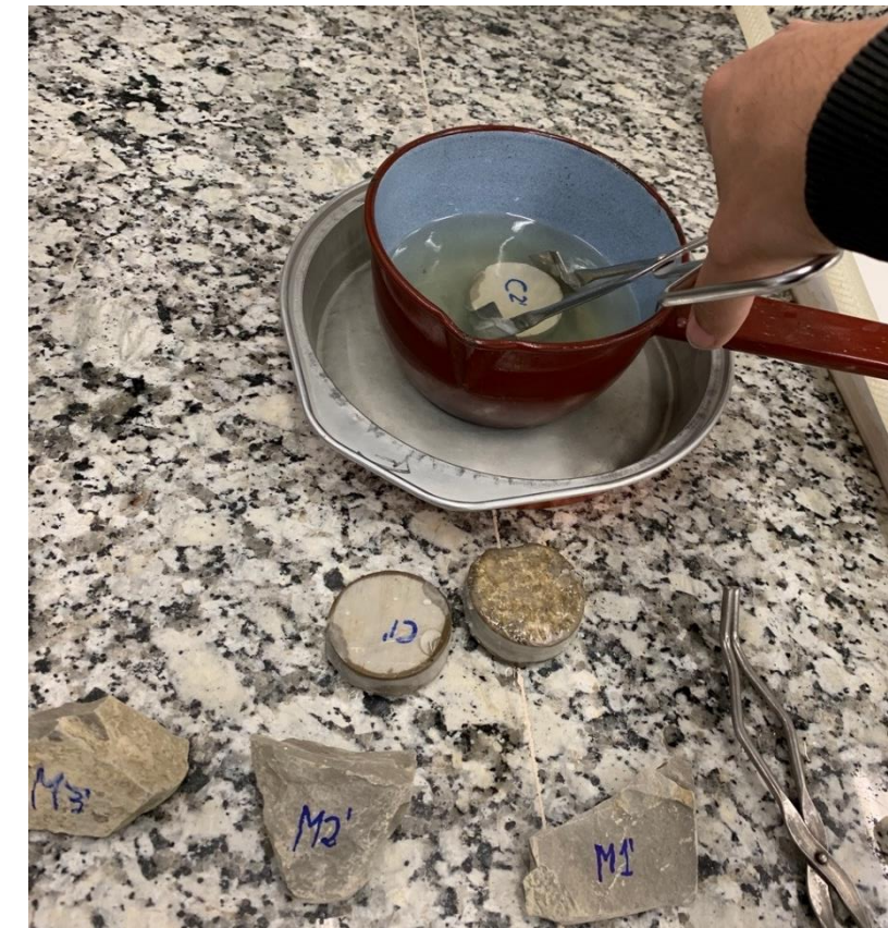
Ilustración 59 Procedimiento de parafinar las muestras. Fuente: Elaboración propia
