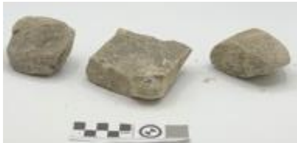
Ilustración 48 Muestras de margas para el ensayo de alterabilidad. Fuente: Elaboración propia.
