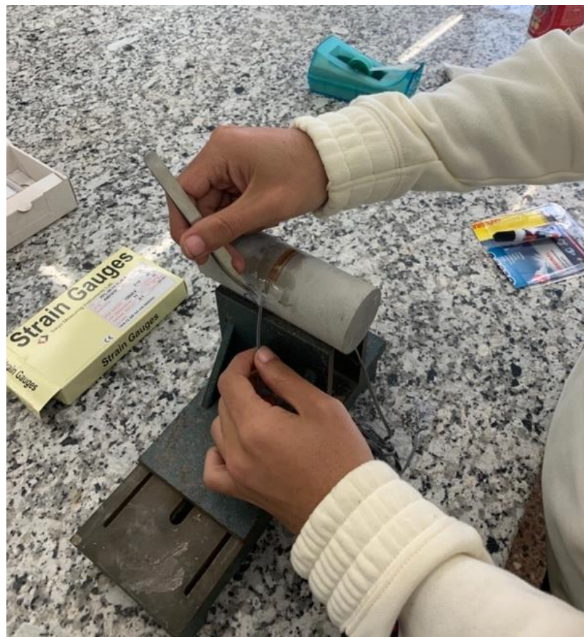
Ilustración 50 Colocación de las bandas a la P2. Fuente: Elaboración propia.
