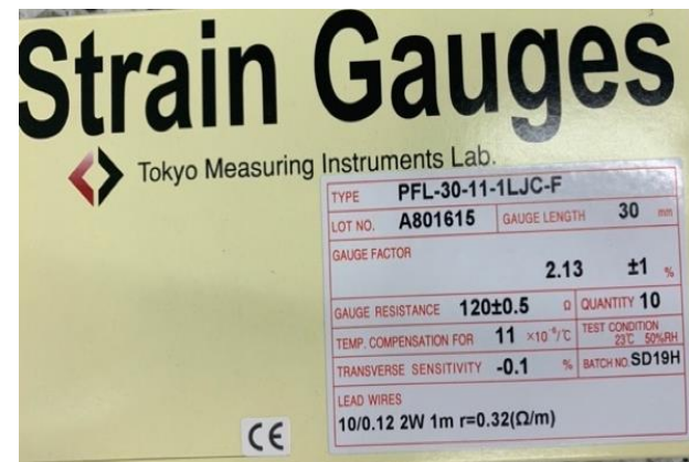
Ilustración 49 Etiqueta informativa de las bandas extensiométricas usadas en el ensayo a compresión simple. Fuente: Elaboración propia
