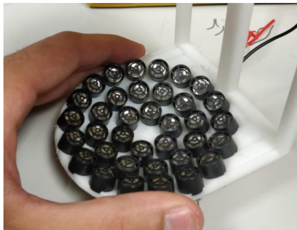
Ilustración 22: Instalación de los transductores en la estructura
