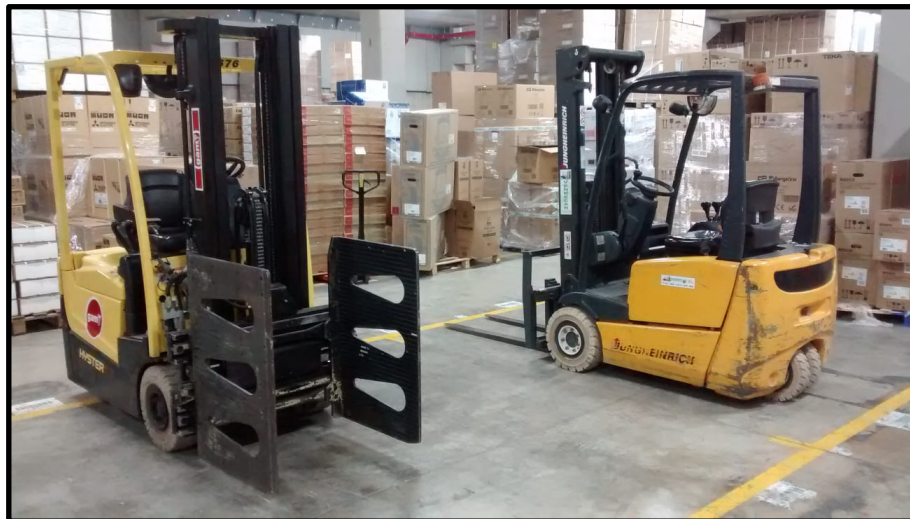
Ilustración 19: Carretillas elevadoras contrapesadas. (Izquierda: Pinzas; Derecha: Palas). Fuente: Elaboración propia.
