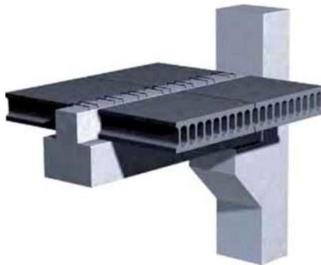
Figura 15. Detalle de apoyo de una viga T en una losa alveolar (Fuente:Alve)
