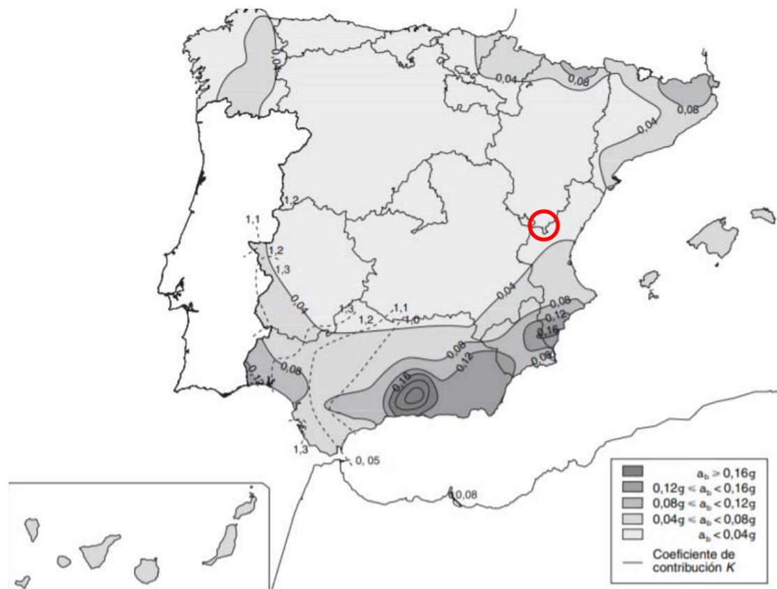
Figura 4.3. Mapa de Peligrosidad Sísmica. Fuente: Norma de Construcción Sismorresistente, NCSE-02
