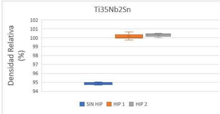
Figura 19. Evolución de la densidad de la Aleación Ti35Nb2Sn con diferentes tratamientos de HIP.
