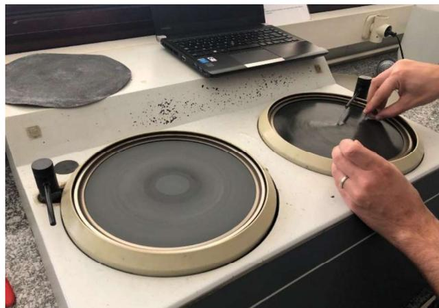
Figura 13. Pulido de probetas
