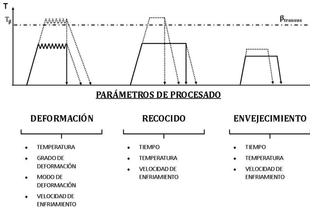
Figura 64. Tratamientos termomecánicos en las aleaciones de titanio. Adaptado de “Titanium and Titanium Alloys Fundamentals and Applications”.
