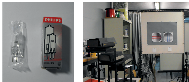
Figura 3.7 Lámpara de proyector Philips de 24V - 150W (izquierda). Disposición del proyector respecto a la dirección de mirada del observador, ángulo de 45^\circ (derecha).
