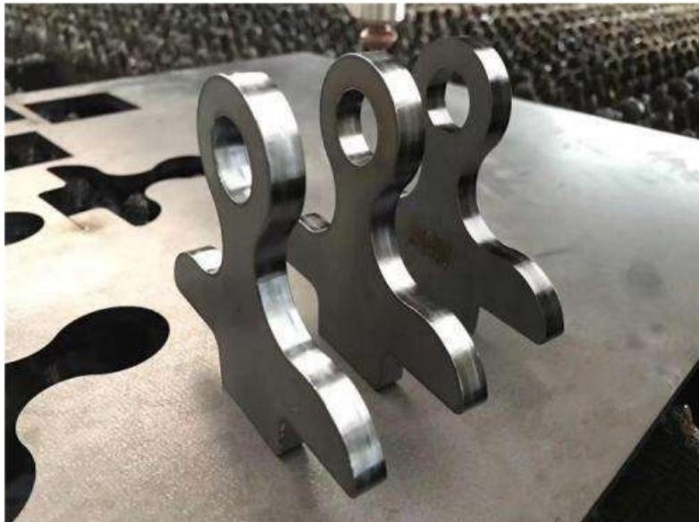
*Figura 64. Corte láser de gran espesor.*
