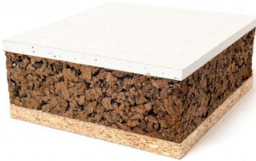
*Figura 55. Ejemplo estructura aislante de corcho.*
