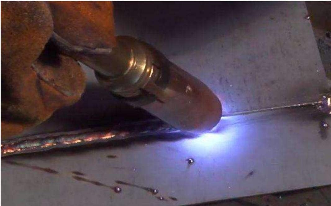
Figura 62. Detalle soldadura MIG.
