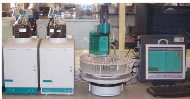
Figura III.3. Componentes del cromatógrafo líquido de intercambio iónico.
