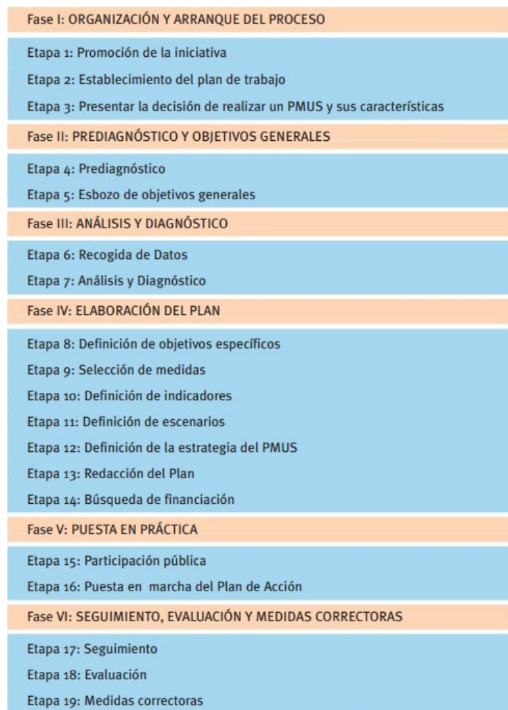
Imagen 6. Fases para la implantación de un PMUS. (Fuente: Guía práctica para la elaboración e implantación de Planes de Movilidad Urbana Sostenible, 2006)
