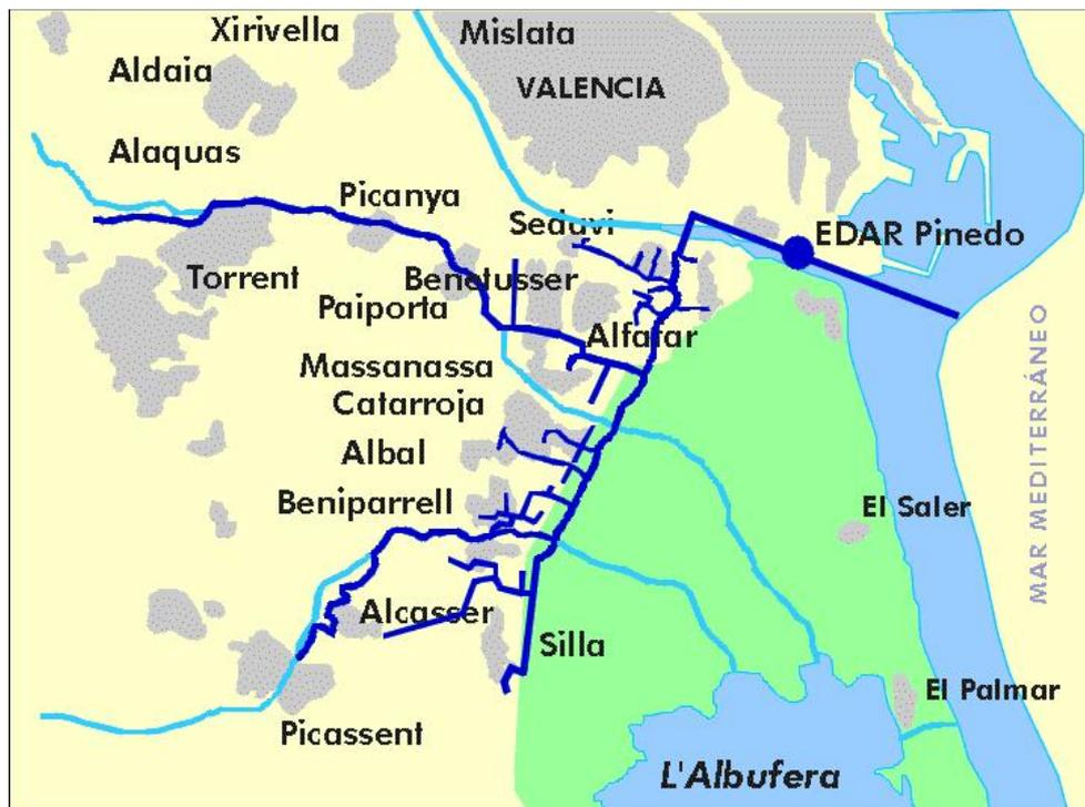
Figura 4. Esquema general del colector oeste. Fuente: Acuamed.
