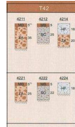
Ilustración 5: Firmes posibles en E1 y E2
