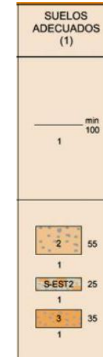
Ilustración 3: Explanadas en suelo adecuado.
