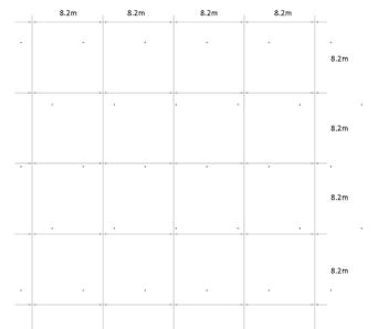
La estructura preexistente consiste en silos de hormigón armado de 15 cm de espesor y 8,2m de diámetro exterior apoyados en una viga circular y pilares de hormigón en la planta sótano.
